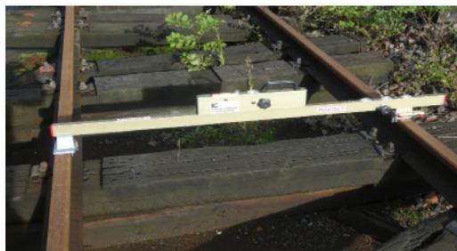
**REGLE de contrôle de l'usure des 1/2 aiguillages - Réf. 582**
